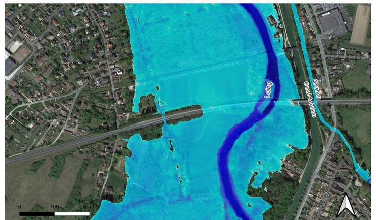
Pour être pertinente, la modélisation s'est appuyée sur une topographie fine (cf. infolettre n°2), une analyse hydrologique complète (cf. infolettre n°4) ainsi que des relevés des niveaux atteints par les inondations historiques. En effet, pour garantir la qualité de la modélisation, il faut mettre en relation les résultats du modèle avec des événements historiques passés : c'est ce que l'on appelle le calage.
