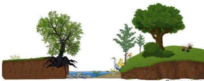
Figure 41 : Schéma du Solin après travaux avec une banquette minérale et un retalutage des berges.
