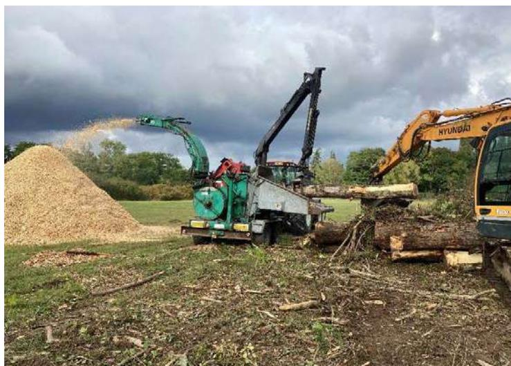
Figure 50 : Broyage des peupliers en vue de leur réemploi dans les cheminements - BEZONDE
