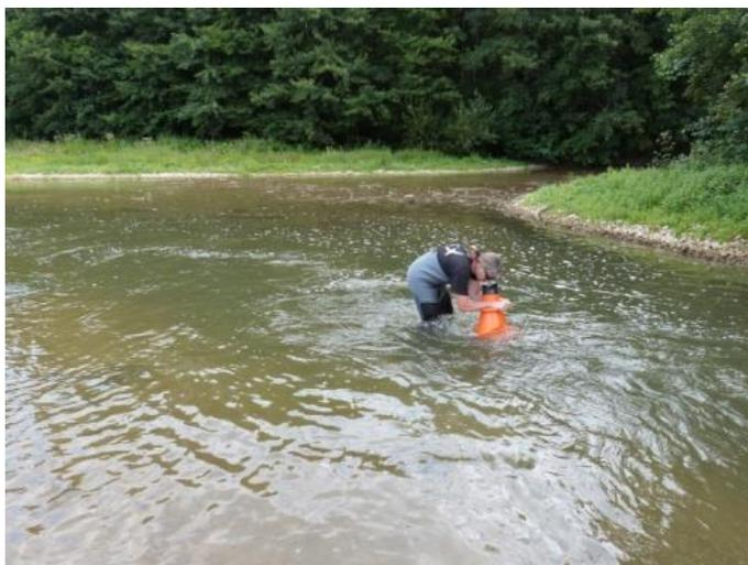
*Le Loing à la station de Montargis le 7/8/2015 a été recalibré et présente des banquettes de végétation qui ont rétréci son lit mineur par rapport à 2011 (photo de gauche). La réalisation de l'IBMR a été effectuée en observant la végétation aquatique à l'aide d'un aquascope (photo de droite) (Photos Dubost Environnement).*
