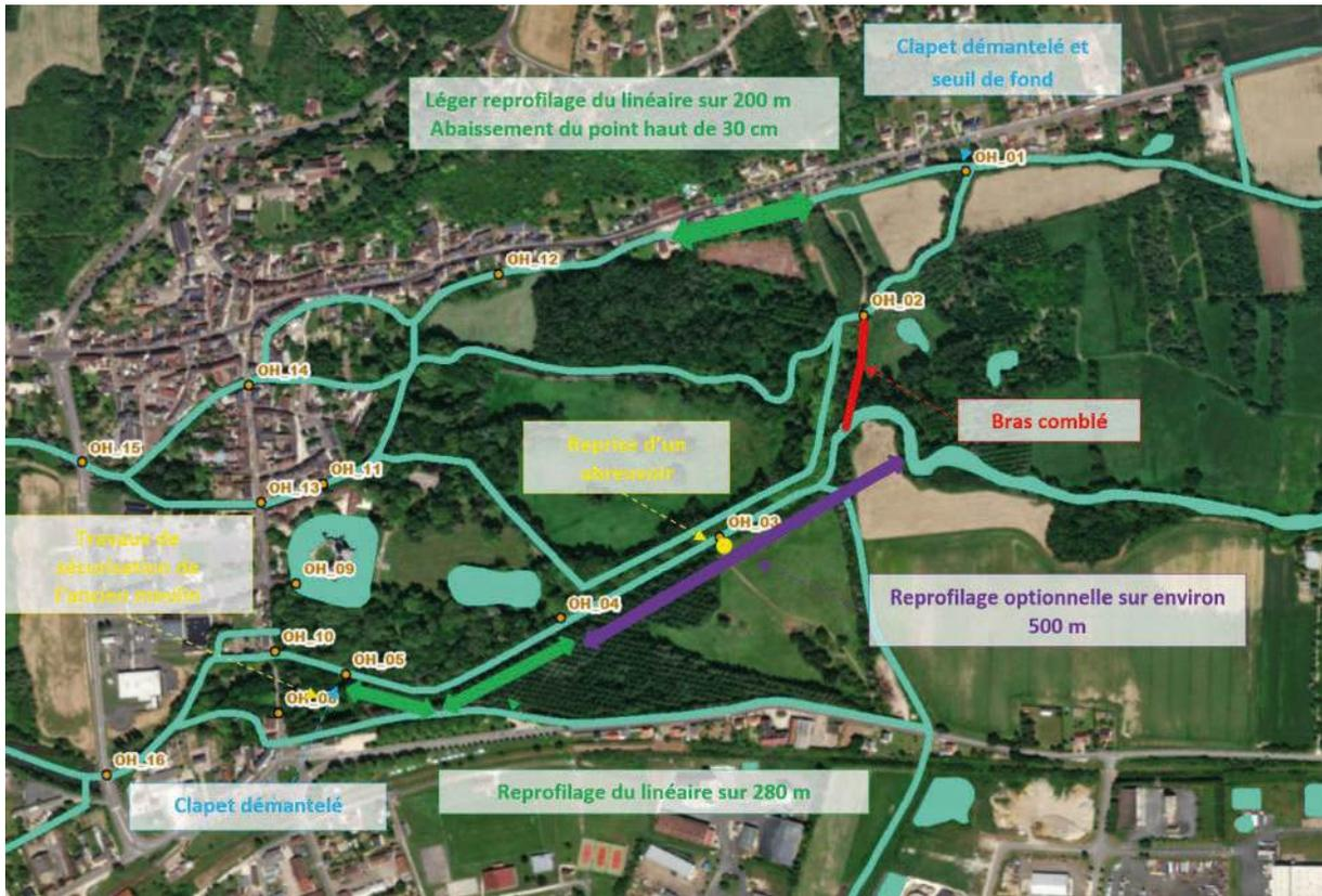
Figure 37 – Schéma de principe des travaux projetés – OUANNE AVAL
