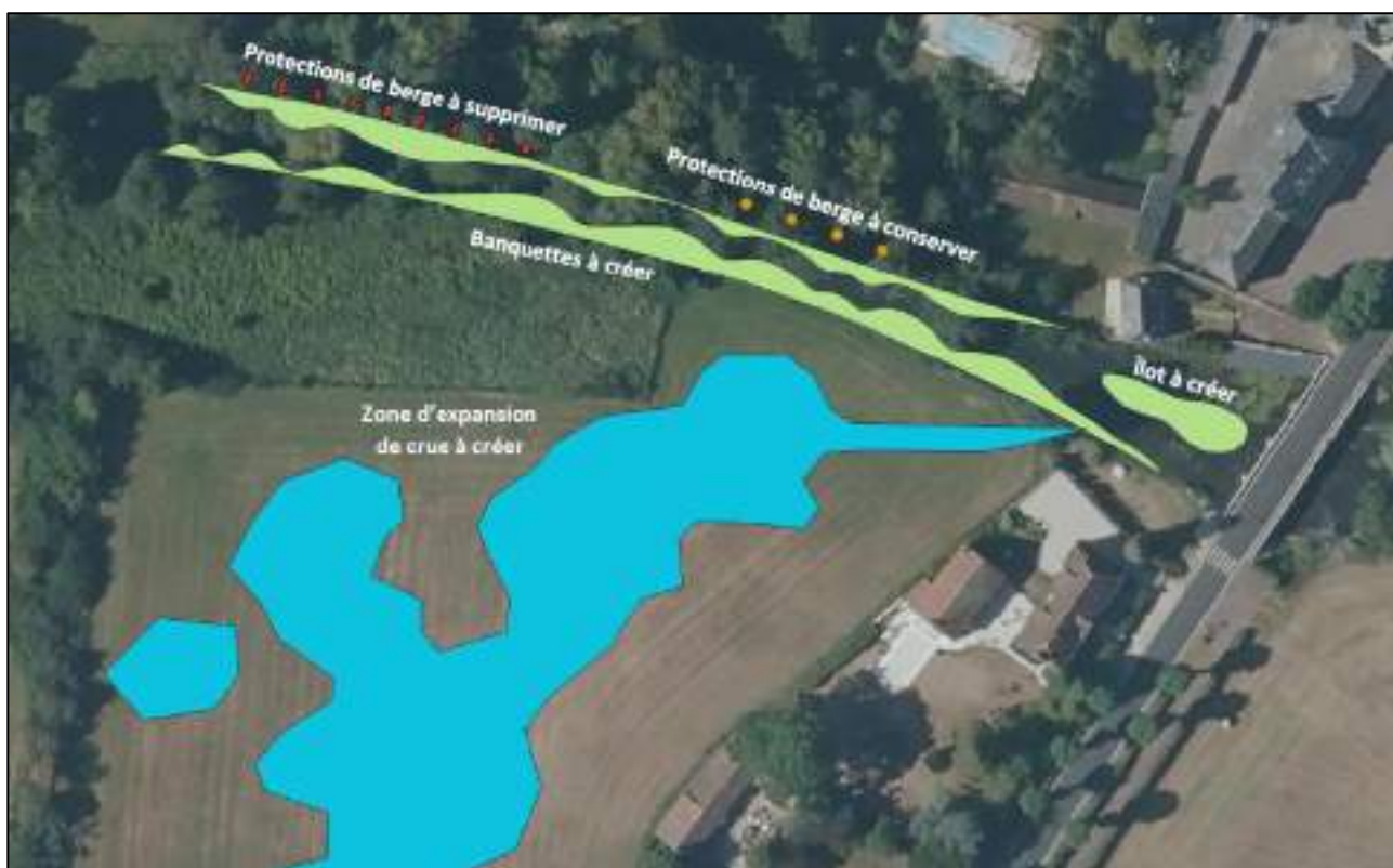
Figure 68 - Schéma de principe des aménagements à La Selle-sur-le-Bied - CLÉRY
