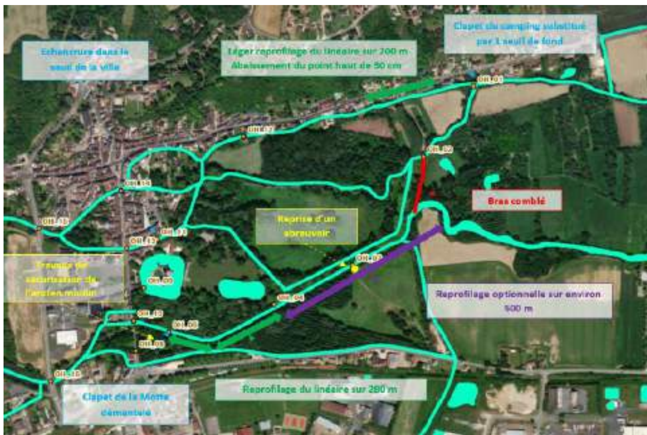
Figure 32 - Schéma de principe des travaux projetés - OUANNE AVAL
